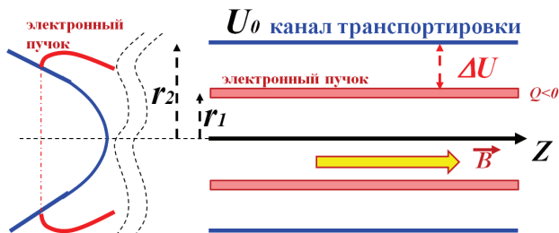
Рис.33. Электронный пучок в канале транспортировки. Слева показана формирующая пучок магнетронно-инжекторная пушка с малым пичч-фактором g \ll 1
